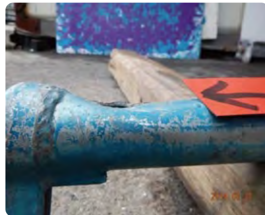
A-7 ・打ち込み部のへこみ重度
