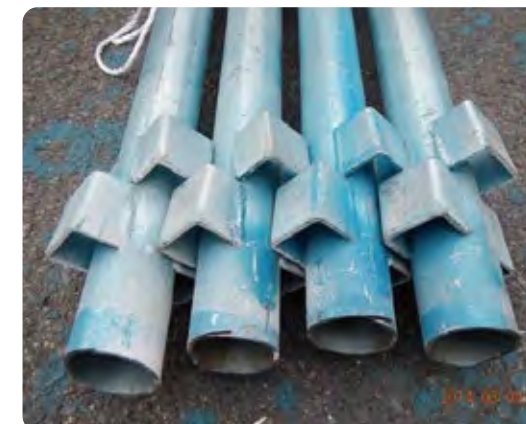
A-5 ・切断、亀裂、穴開き等の破損
